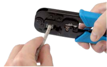
3/ Crimpar para terminar el conexionado
